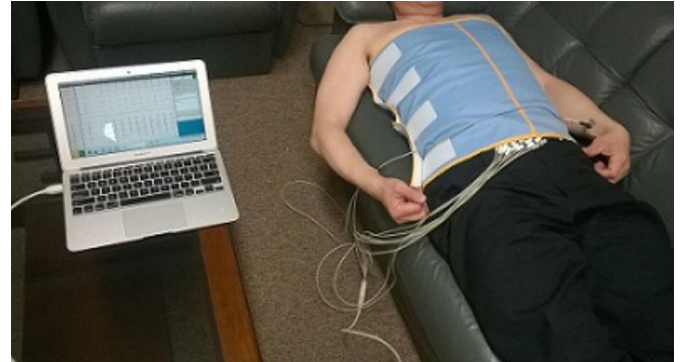
帝人 株式会社のHP より 心電計測ウェアラブル電極布の開発風景
